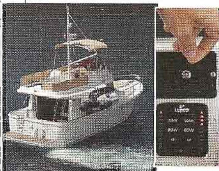
Propulseur de poupe vers la gauche, de poupe vers la droite, et le bateau pivote sur lui-même. Un jeu d'enfant mais attention aux batteries.
