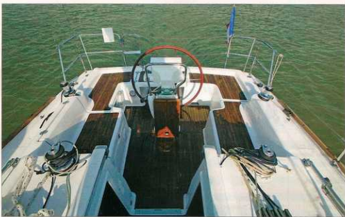
Le barreur apprécie de circuler aisément autour de la barre et de trouver les winches de génois à portée de main.
