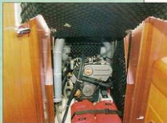
Au premier plan, devant le bâti du Yanmar 3 YM20 (21 ch), les deux batteries de 70 Ah.
