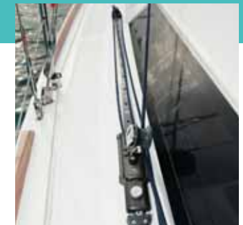
Pack easy sail: Réglage du chariot de génois au cockpit • Easy sail pack: genoa traveller trimming from cockpit • Pack easy sail: Regolazione carrello genoa in pozzetto • Pack easy sail: Reglaje del carro escotero de genova en la bañera • Easy sail Pack: Genuaschlittenverstellung vom Cockpit aus
