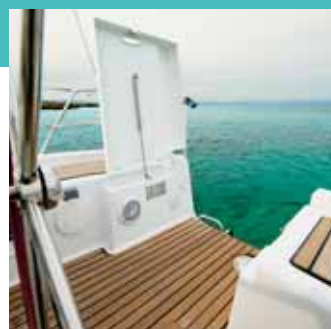
Banc barreur pivotant avec ouverture assistée par vérin à gaz en inox • Pivoting helmsman's bench seat with stainless steel gas strut-assisted lid • Seduta timoniere girevole con apertura assistita con attuatori in inox a gas • Asiento skipper pivotante con abertura asistida por retenedor a gas inox • Schwenkbare Steuersitzbank mit Niro-Gaszylinder zum Öffnen
