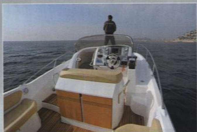
Le Flyer 850 Sun Deck, proposé par Bénéteau, dispose de larges passavants latéraux facilitant l'accès au pontage surélevé à l'avant du bateau.
