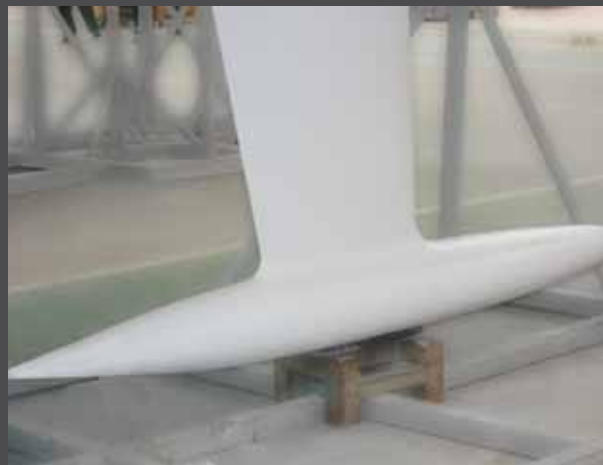
La quille en T / The T-shaped keel
